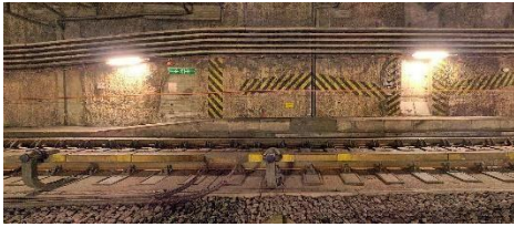
Orthobildabwicklung Tunnellaibung, Abwicklung 3D Punktwolke in Echtfarbdarstellung
