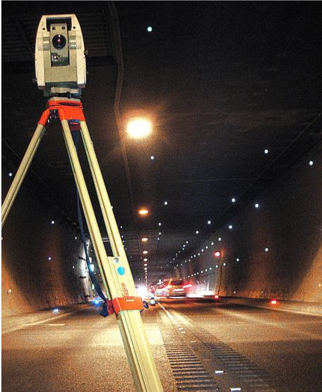
3D-Verschiebungsmessung bei halbseitiger Tunnelsperre
