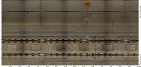
Hochauflösende Scanaufnahme, Orthobildabwicklung Oberbau und bahntechnische Ausrüstung
