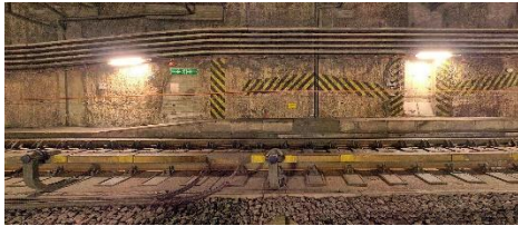
Orthobildabwicklung Tunnellaibung, Abwicklung 3D Punktwolke in Echtfarbdarstellung
